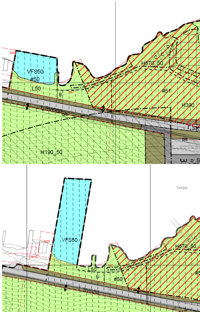
Figur 5.3. Plassering av drenering ut frå tunell i vedteken plan (øyst) og i endra plan (lengst ned)
