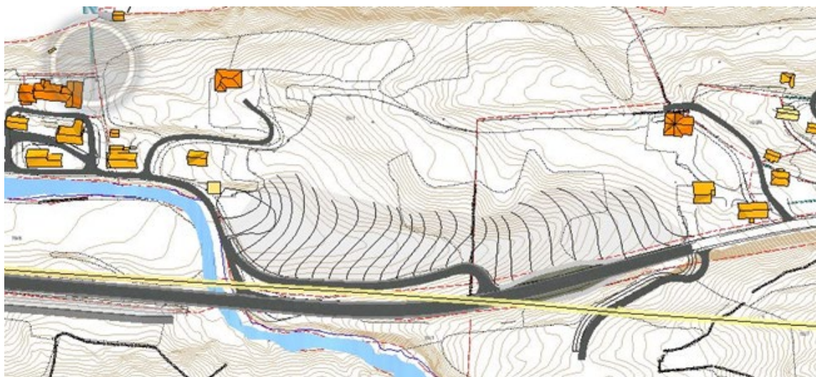
Figur 4.3. Deponi Heilevang. Mørk grå viser nye vegar. Lys grå viser deponiområdet med høgdekoter.
