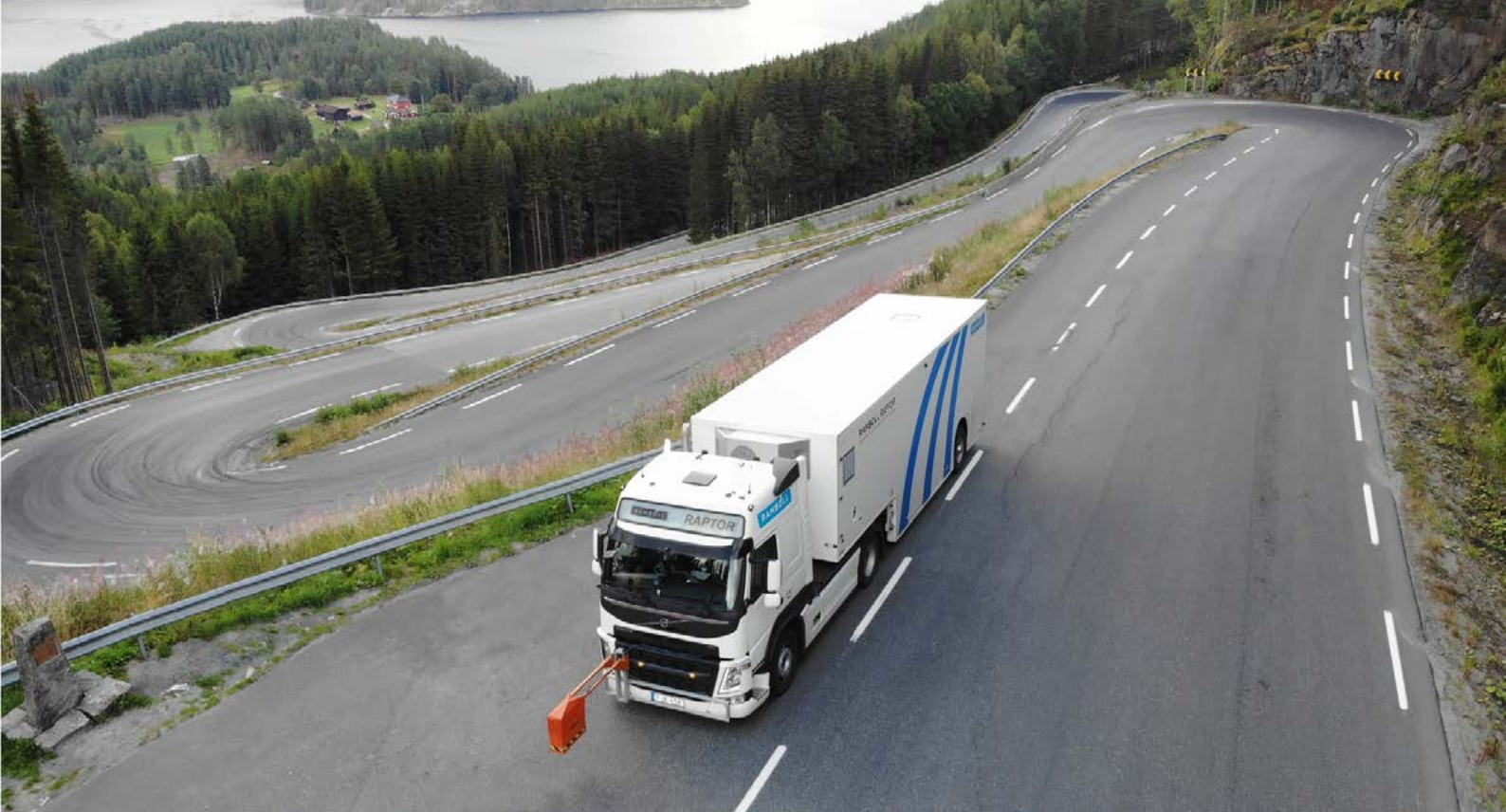
Figur 9 viser Raptor-bilen som målte fylkesvegnettet i 2023. Foto: Rambøll.
